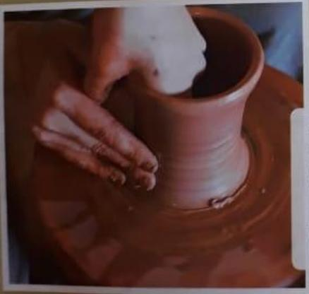
Los materiales cerámicos, como la porcelana, se obtienen a partir de una mezcla de arcilla o arena con agua. Luego la masa se moldea y se cocina a altas temperaturas.
